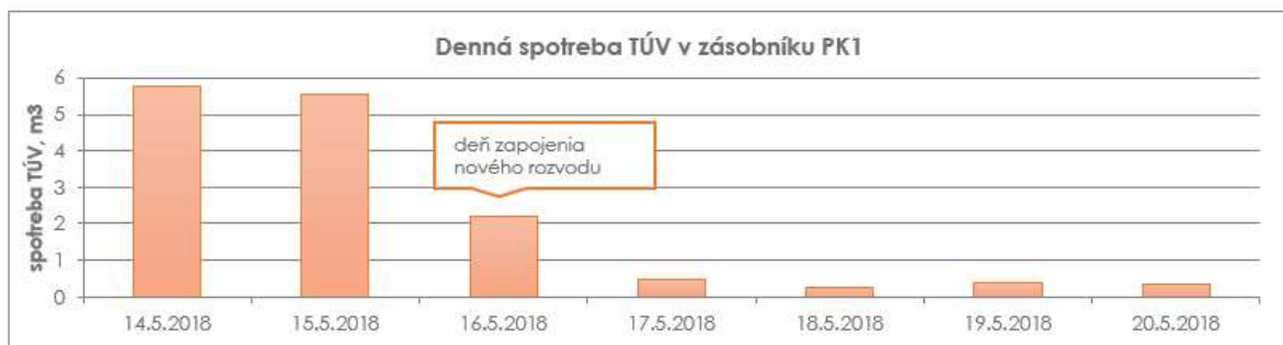
Graf č. 2 – Denná spotreba TÚV v m 3 pred a po výmene rozvodov TÚV v priestoroch garáží a dielní
